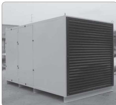
Ventilatore centrifugo con cassone afonizzato, sileziatore, griglie di aspirazione con profilo anti-pioggia apribili per ispezione parete filtrante efficienza G4 / F7 più stadio batteria elettrica
